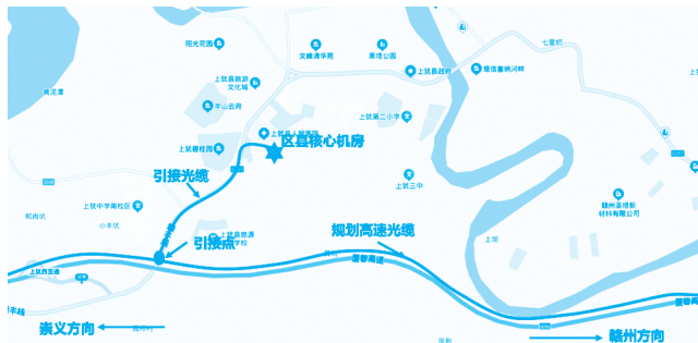
图1 高速光缆引接示意图
